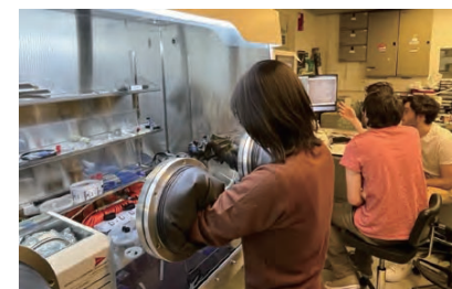
グローブボックスでの二次元物質の劈開作業
