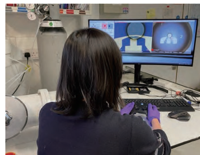
トランスファーステムを用いた二次元物質のデバイス作製
