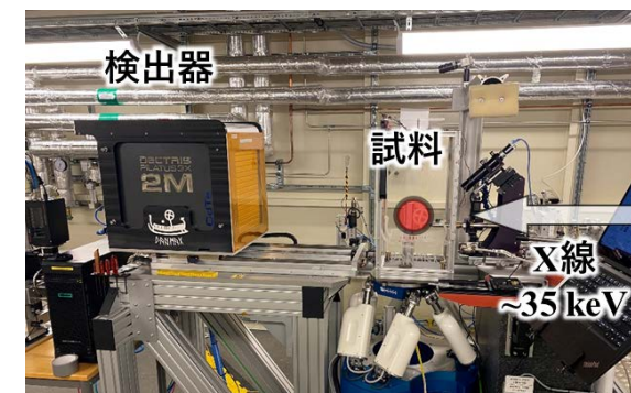
右側から左に向かってX線が入射、赤い丸で示した試料で回折したX線を左側の検出器で観測
