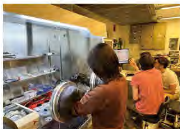
グローブボックスでの二次元物質の劈開作業
